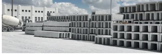
Metrobüs drenaj kanalları
